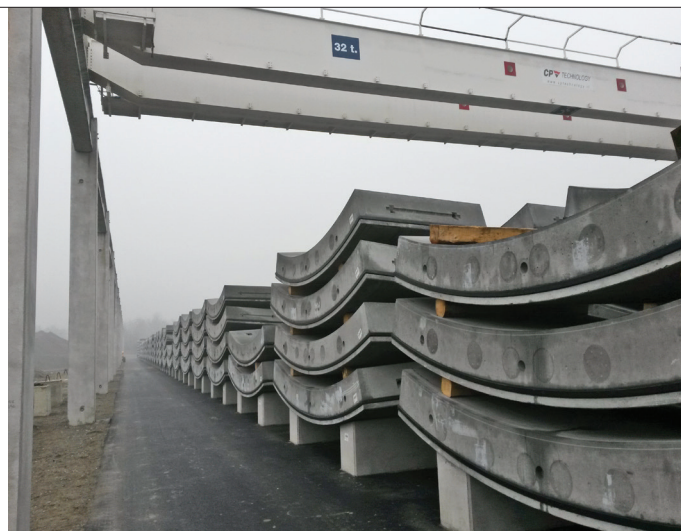
3. Lo stoccaggio nei pressi dell'impianto di produzione dove avviene la "maturazione" del concio
