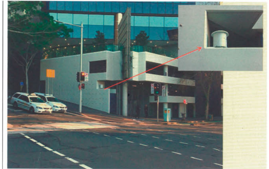
Bild 2: Totalstation an der Kreuzung Margaret Street/Kent Street
