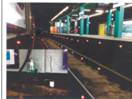
Bild 3a (oben): Installation von mehr als 70 Prismen an den Gleisen der Wynyard-Station zur Überwachung der Sollgeometrie, Spurweite und Überhöhung
