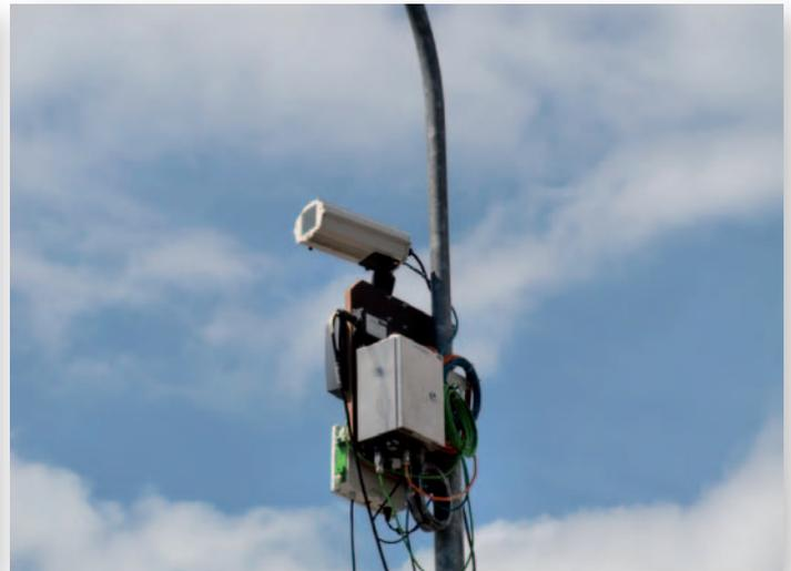
Bild 6: Ein „Meshnode“ als Datensammelstelle, hier mit einer Kamera direkt an einem Schulhof (Foto: Sterzik)
