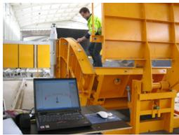
vermessen werden. Bei der Herstellung von Rotorblättern für Windenergieanlagen gilt es sowohl die Form zu vermessen, in der die Rotorblätter in einem Laminierprozess hergestellt werden, als auch die fertigen Rotorblätter selbst.
