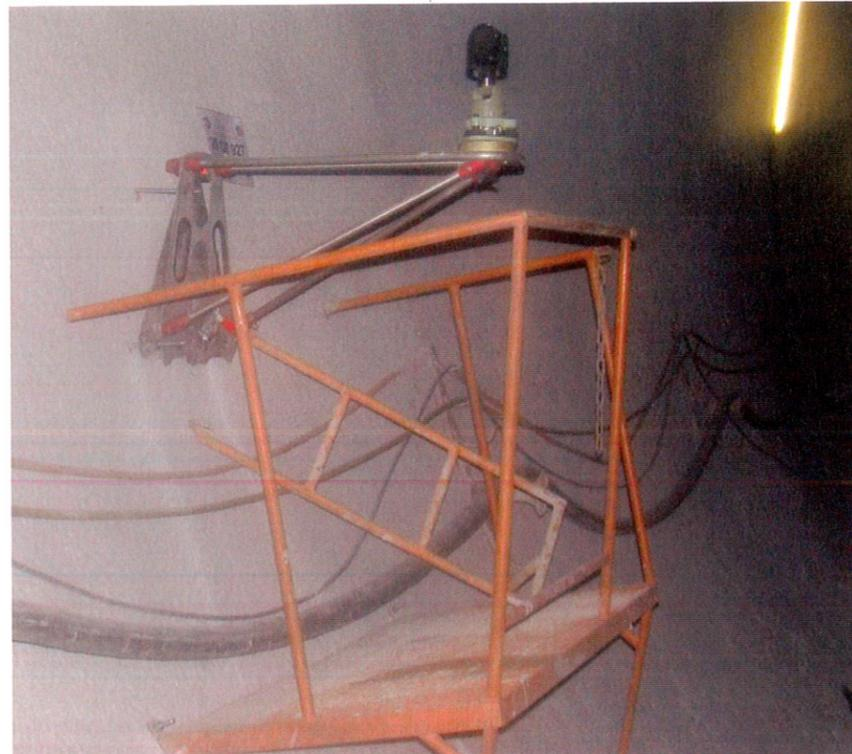
Abb. 7: Messkonsole mit Standbühne.
